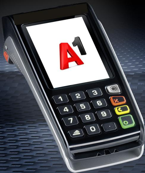
Leistungsstarkes stationäres Bezahl-Terminal mit bedienerfreundlichem Design für die Anwendung am Point of Sale. Das Bezahl-Terminal kann durch den integrierten Belegdrucker sowohl im stand-alone Betrieb, als auch angebunden an ein Handlungskassensystem, verwendet werden.
